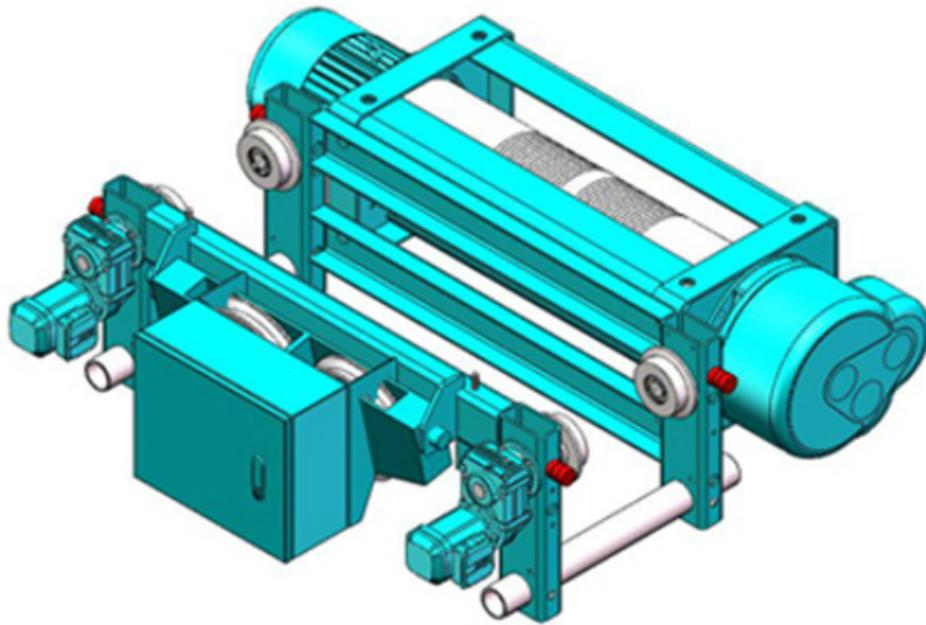
一、钢丝绳葫芦简介□KMD型钢丝绳葫芦，为欧式结构，主要分为：固定式、下挂运行式、低净空运行式、双梁小车运行式。下挂运行式、低净空运行式、双梁小车运行式可分别配置在单梁起重机、悬挂起重机和桥式起重机上。固定式是卷扬机的一种形式，可做垂直提升、水平或倾斜曳引重物的简单起重机械。二、钢丝绳葫芦特点：1. 方形结构，安装方向多样；2. 起升、水平或倾斜曳引重物的简单起重机械；3. 所有连接采用快插式重型航空插头插座，密封好，接插牢固，便于维护；4. 插头连接部位采用塑料套管绝缘保护；三、安全可靠：1. 上升及下降限位；2. 超载限制器；3. 控制部分，配置急停开关、短路保护、失压保护、相序保护等功能。马鞍山钢丝绳葫芦怎么选钢丝绳葫芦，方形结构，规格齐全，性能优越，南京生产。
