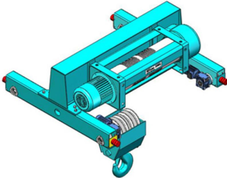
一、钢丝绳葫芦简介□KMD型钢丝绳葫芦，为欧式结构，主要分为：固定式、下挂运行式、低净空运行式、双梁小车运行式。下挂运行式、低净空运行式、双梁小车运行式可分别配置在单梁起重机、悬挂起重机和桥式起重机上。固定式是卷扬机的一种形式，可做垂直提升、水平或倾斜曳引重物的简单起重机械。二、钢丝绳葫芦特点：1. 方形结构，安装方向多样；2. 起升、水平或倾斜曳引重物的简单起重机械；3. 所有连接采用快插式重型航空插头插座，密封好，接插牢固，便于维护；4. 插头连接部位采用塑料套管绝缘保护；三、安全可靠：1. 上升及下降限位；2. 超载限制器；3. 控制部分，配置急停开关、短路保护、失压保护、相序保护等功能。
